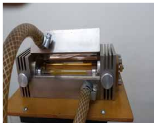
شکل ۸: کاواک تک بیضی لامپی آب خنک مورد استفاده برای تست میله های آنیل شده در ازت و هوا
