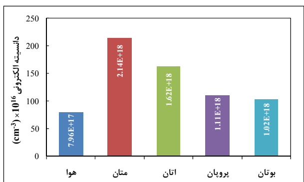
شکل ۶. دانشیته الکترونی پلاسمای القایی لیزری در محیط‌های مختلف گازی در حضور هدف پالادیم.
