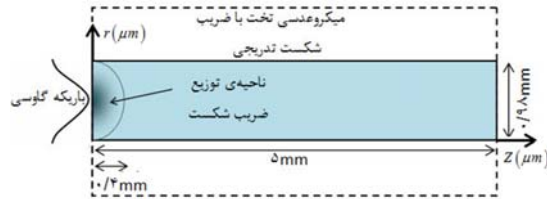
شکل ۱. مشخصات ابعاد میکروعدسی تخت با ضریب شکست تدریجی
