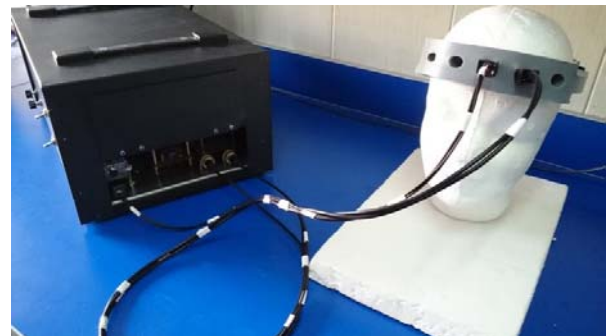
شکل ۱: نمایی از دستگاه fNIRS لیزری ساخته شده در آزمایشگاه تصویربرداری بیولوژیک نوری پژوهشکده لیزر و پلاسما.
